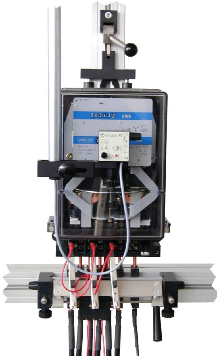
Die Schnellspannvorrichtung QCD wird in Verbindung mit Zählerprüfeinrichtungen verwendet und wird überall dort eingesetzt, wo zum Zwecke der Justierung und Beglaubigung Elektrizitätszähler schnell und zeitsparend aufgehängt und kontaktiert werden müssen.
